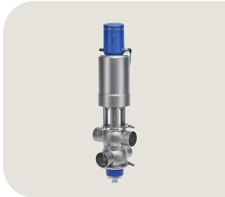
der Ferne gesteuert wird. Das Ventil hat zwei unabhängige Kegel und Dichtungen zur Trennung der Flüssigkeiten; der Raum zwischen den Dichtungen bildet bei jedem Betriebszustand eine Leckagekammer bei atmosphärischem Druck. Leckage tritt nur selten auf, aber sollte sie auftreten, läuft das Produkt in die Leckagekammer und tritt durch den Bodenauslass aus, so dass es leicht zu erkennen ist.
